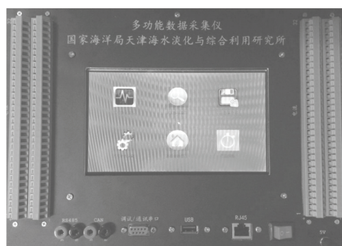
图2 数据采集端实物
