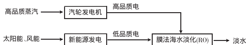
图5 新能源海水淡化示意图
