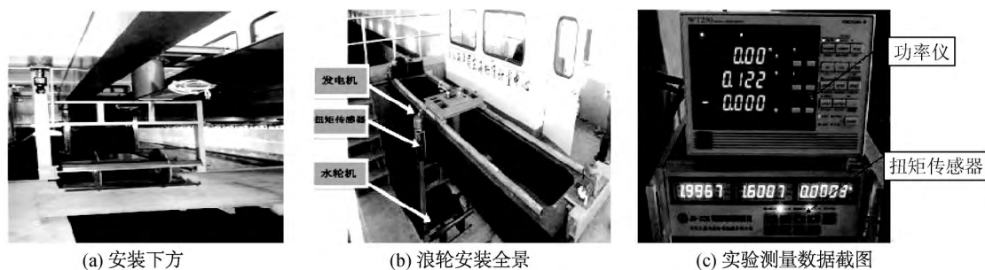
图9 浪轮发电装置水槽实验安装方式
