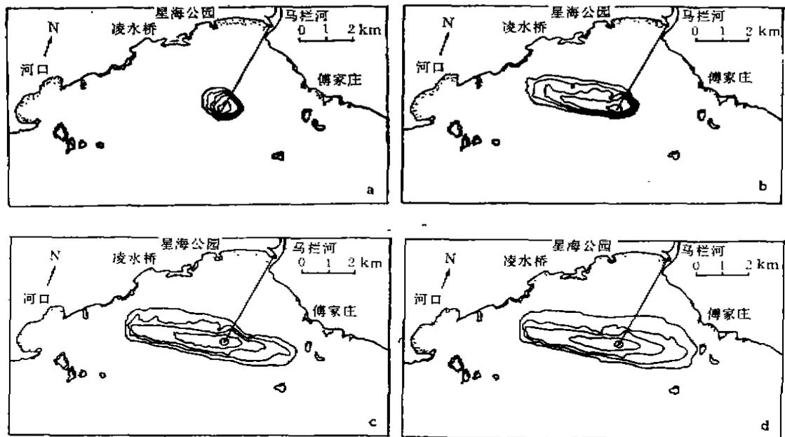
图1 大连市黑石礁湾污水排海工程方案A污染羽流访问频率场
