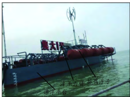
图3 多点阵列式波力发电装置
