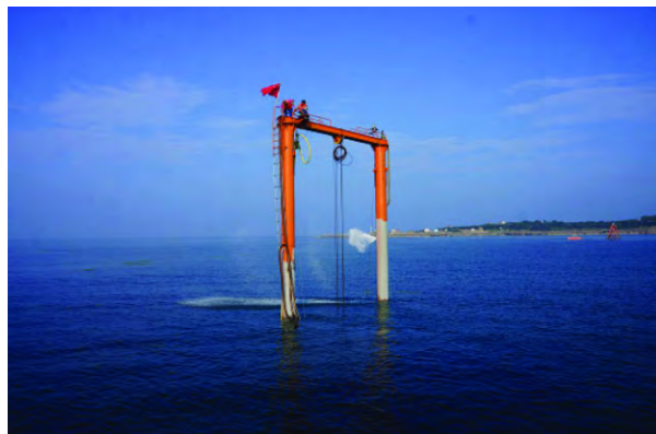
图 9 20 kW 潮流能发电装置
