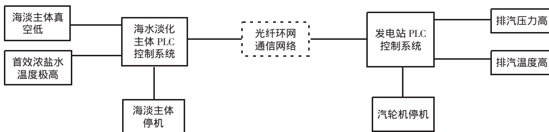
图 6 联锁保护停机控制框图
