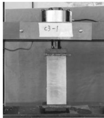
图 1 单轴压缩实验加载示意
