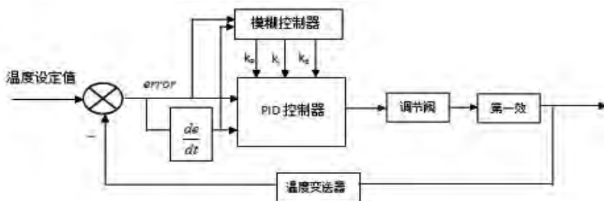
图 4 第一效浓盐水温度控制系统框图
