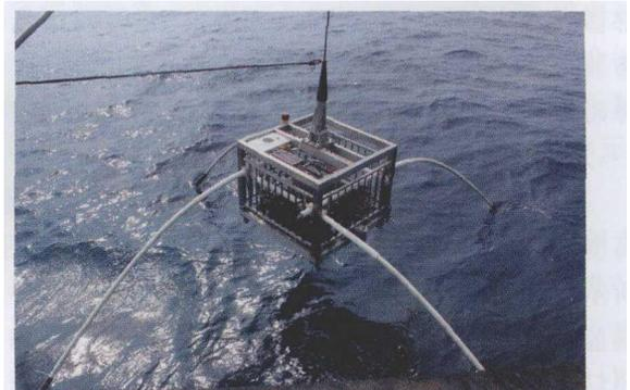
图10 坐底式发射机
