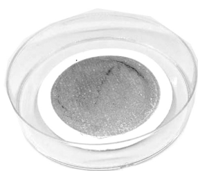
图2 以微孔滤膜为基底 CuO 纳米颗粒薄膜
