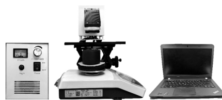
图3 简易太阳能蒸发实验平台
